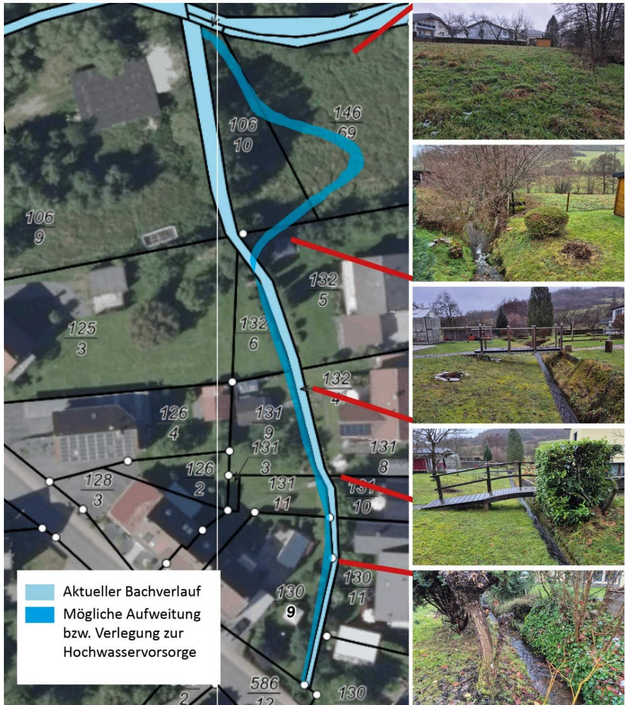
Abb. 1: Maßnahmenskizze zur Aufweitung und Laufverlegung des Dreisbaches
