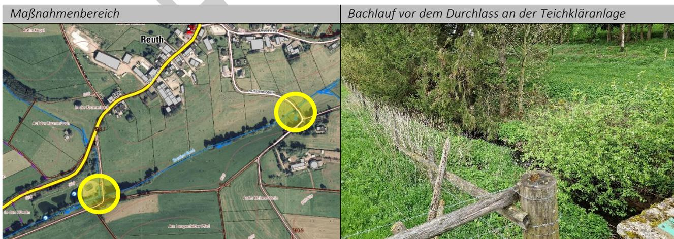
vorgeschaltetes Sperrbauwerk (bspw. Trägerbohlenwand) mit gedrosseltem Abfluss, könnte der Durchlass an der Kläranlage entlastet werden. Durch zusätzliche Erhöhung des Wegedammes, in Verlängerung der Straße „Auf dem Stein“, könnte auch das Rückhaltevolumen vergrößert werden. Dies müsste im Rahmen einer Vorplanung geprüft werden.
