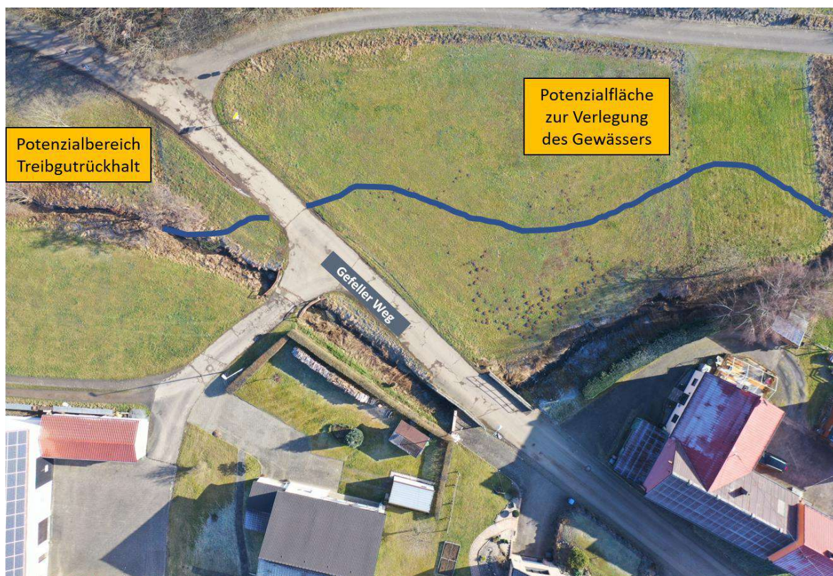
Abb. 12: Verlegung des Sarmersbaches im Gefeller Weg
